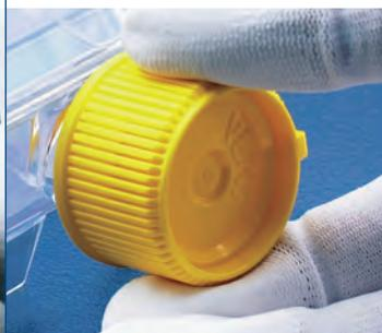
*Ein Klick, und Sie sind in der «VENT»-Position der Schraubkappe mit definierter Belüftung. Sie erkennen auch die eingerastete «VENT»-Position am leicht hervorstehenden Rechteck, welches dann auf 12 Uhr steht. Dreht man die Schraubkappe um 90° Grad weiter, so ist die Flasche gasdicht verschlossen.*
