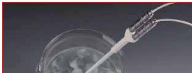
In der Praxis heißt das: Sie lassen den Thermofühler in einem Eiswasser-Bad einen Dauerwert erreichen. Dann wird der Fühler schnell in eine Säule mit Wasserdampf gegeben und dabei der Widerstand überwacht, bis ein Dauerwert erreicht ist.
