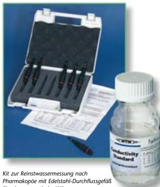
Kit zur Reinstwassermessung nach Pharmakopöe mit Edelstahl-Durchflussgefäß für pharmazeutische Wässer.
