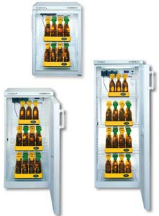
die Arbeit mit dem System OxiTop® Control geeignet, da der Datenabruf durch die geschlossene Glastür erfolgen kann. Dies hat den Vorteil, Temperaturschwankungen durch Öffnen der Tür zu vermeiden.
