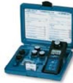
**Kleines, tragbares Trübungsmessgerät zur Überprüfung**
