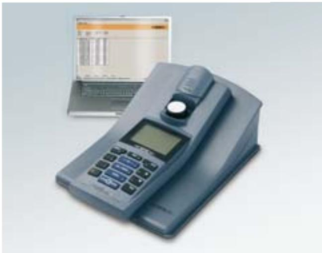
Die Messung und automatische 3-Punktkalibrierung läuft selbsterklärend und menügesteuert ab. Die Kalibrierung erfolgt über ein AMCO®-Standardset (0.02-10-1000 NTU). Bis zu 1000 Datensätze inkl. Identnummer können gespeichert und später GLP-gerecht über die LabStation mit der leistungsstarken Software LSdata ausgegeben werden (s. S. 90).
