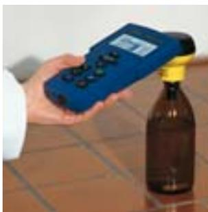
Controller, dem OC 100. Mit diesem System können 100 Messköpfe gleichzeitig, auch in Gruppen zusammengefasst, über den Controller gestartet, verwaltet, gespeichert und mit graphischer Auswertung auf einem großen Display verfolgt werden. Über das Kabel **AK-540/B** (Bestell-Nr. 902 842) und das Kommu-
