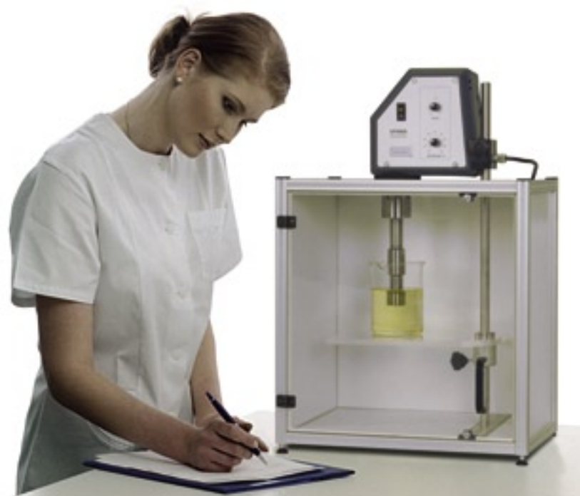
UP400S mit H22 in Schallschutzbox
