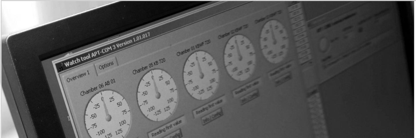
Softwarepaket APT-COM™ 3 DataControlSystem für Windows für die Vernetzung von bis zu 30 Geräten bzw. Reglern mit der Kommunikationsschnittstelle RS 232, RS 422 oder Ethernet für die Steuerung, Programmierung und Messdatenerfassung.
