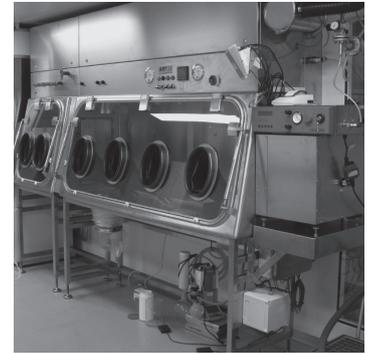
Vakuum-Trockenschrank an Glovebox
