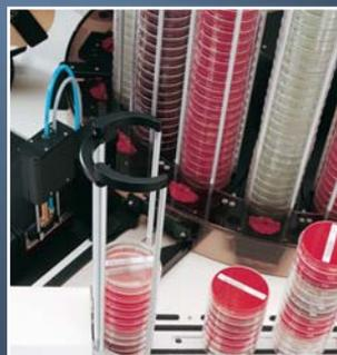
Am Förderband stehen bis zu 8 Stapel mit max. 20 Platten pro Stapel zur weiteren Bearbeitung bereit.
