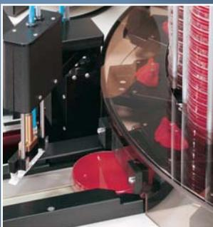
Die Beschriftung der Petrischalen erfolgt batchweise oder nach Auftragsliste aus der Labor-EDV.
