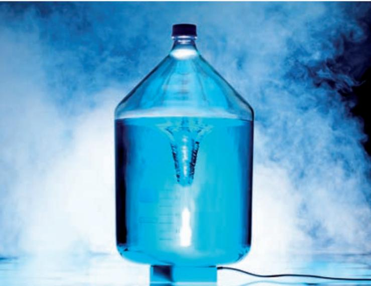
Sehr kräftige Magnetkopplung, daher prädestiniert für Kraftübertragung über größere Distanzen oder für dicke Gefäßböden. Wartungsfreier 2mag-Motor-Antrieb mit breitem Drehzahlbereich von 100 bis 1.200 rpm.
