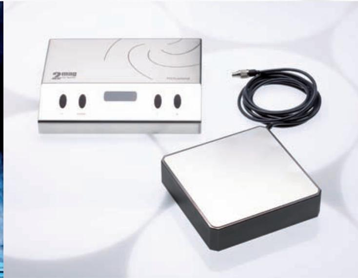
SoftStart-Funktion (4-stufig einstellbar) für zuverlässiges Fangen/Zentrieren und sicheres Beschleunigen des Rührstabes, einstellbare Intervall-Funktion für zeitabhängigen Neustart einstellbare Intervallzeiten für automatischen Neustart des Rührers nach bis zu 240 Sekunden.
