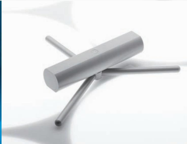
Hocheffektiver, auf Dreibein-Konstruktion gelagerter Rührstab aus abriebfestem ZEDEX, besonders geeignet für große Volumina, viskose Medien in Edelstahlbehältern und dem Einsatz mit abrasiven Stoffen, wie z.B. Sand oder Feststoffen im Medium.
