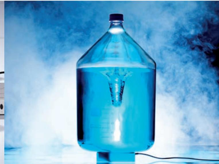
Eine absolute Neuheit ist das integrierte berührungsfreie Rührstab-Monitoring mixWATCH. Sobald die magnetische Kopplung zwischen Magnetrührer und Rührstab aufgrund einer zu hoch eingestellten Drehzahl oder sich verändernden Viskositäten verloren geht, wird der Rührer gestoppt, der Rührstab neu zentriert und wieder sanft beschleunigt.
